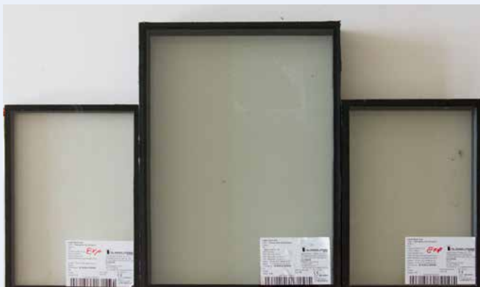
Fig 2. Rudetyper. 2-lags energirude med jernfattigt glas (tv) og 3-lags standard energirude (th) I midten 3-lags energirude med jernfattigt glas som supplerende reference i laboratoriemålinger
